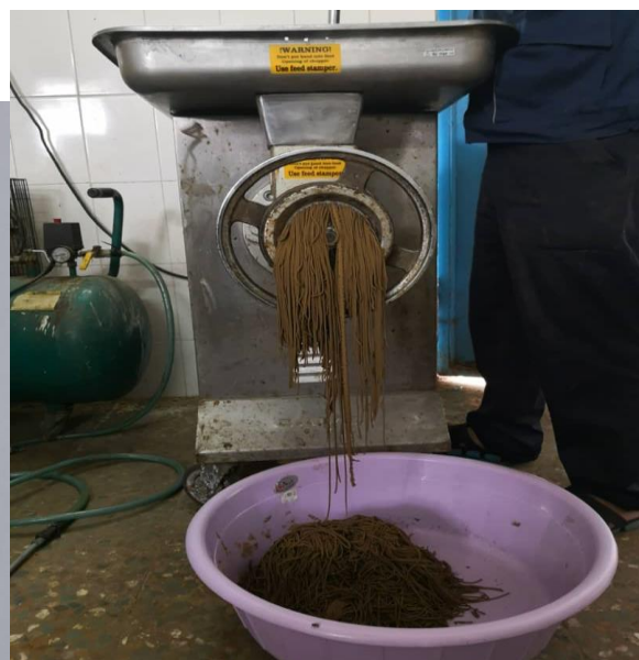
شکل ۴-۲- عبور مواد اولیه غذایی جیره لاروی از چرخ گوشت صنعتی (راست) و غذای لاروی خشک و پودر شده (چپ)
